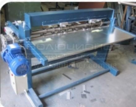
Распускной станок (штрипсорез, станок для резки листового металла) предназначен **для продольного и поперечного реза листового и рулонного металла на полосы заданной ширины**. Используется для продольной и поперечной резки листовой стали до 1,0 мм, алюминиевых композитных панелей до 5 мм, листового ПВХ, бумаги, картона.
